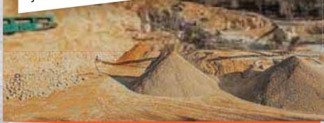
Za spravljanje betona koristimo drobljeni krečnjački agregat sa našeg kamenoloma, deklariranih frakcija, kontrolisane vlažnosti. Kompletan proces proizvodnje i kontrole kvaliteta vršimo prema važećim standardima.
