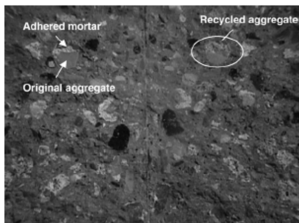
Slika 9. Snimak uzorka BRA-a pomoću optičkog mikroskopa – uočljiva zrna recikliranog agregata sa adhezanom starom cementnom pastom. 5
