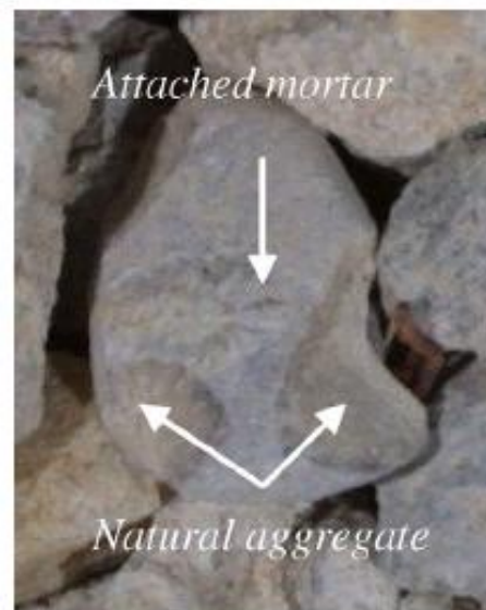
Slika 1. Izgled usitnjenog recikliranog betona: prirodni agregat ( natural aggregate ) i zaostala stara cementna pasta ( attached mortar ) 1 .
