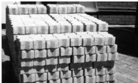
Slika 14. Izgled prefabrikovanih elemenata od betona sa recikliranim agregatom
