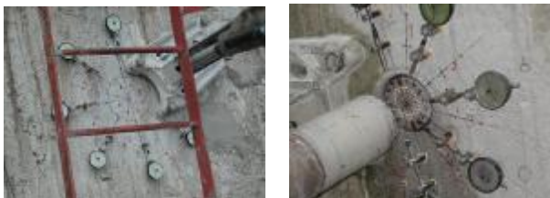
Slika 2. Upotreba dilatometara i mjernih satovi (ugibomjera) kod utvrđivanja postojećeg stanja napona na AB konstrukciji [4]
