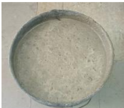
Slika 5a – Određivanje otpornosti na segregaciju samougrađujućih betona pomoću "Sieve segregation resistance test"-a (priprema i merenje mase)
