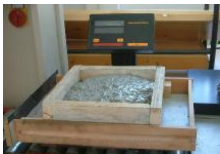
Slika 5b – Određivanje otpornosti na segregaciju pomoću "Sieve segregation resistance test"-a – nastavak (ceđenje i ostatak na dnu)
