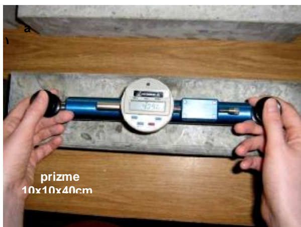
Slika 24 - Merenje skupljanja pomoću deformetra (a) i pomoću komparatera (b)
