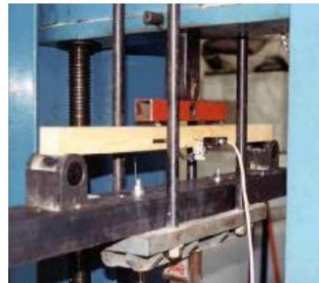
Slika 4. Ispitivanje modula elastičnosti pri savijanju || vlaknima
