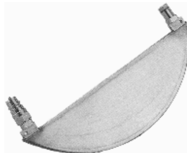
Slika 5. Uređaj za nanošenje sile na prošlicano mjesto u betonskoj konstrukciji [7]
