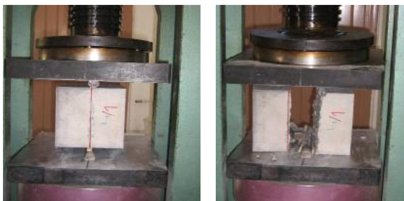
Slika 9 - Ispitivanje čvrstoće betona na zatezanje cepanjem
