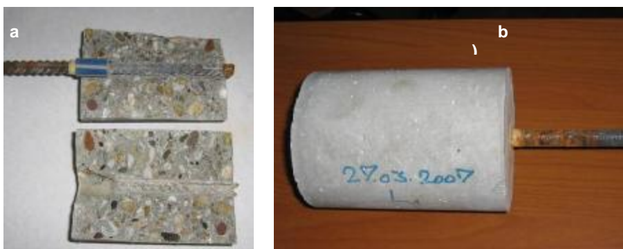
Slika 21 – Rebrasta armatura – lom betona (a), glatka armatura - proklizavanje (b)
