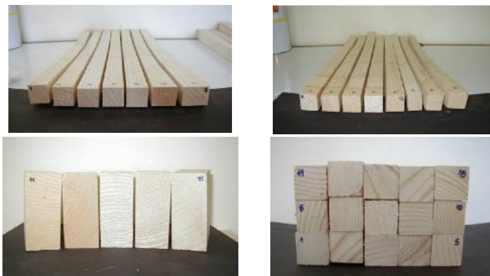
Slika 8. Drvena četinarska građa I klase - ispitivanje mehaničkih svojstava
