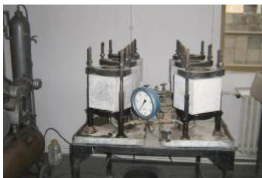
Slika 14 - Ispitivanje vodonepropustljivosti betona
