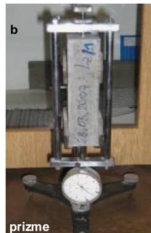
Slika 24 - Merenje skupljanja pomoću deformetra (a) i pomoću komparatera (b)
