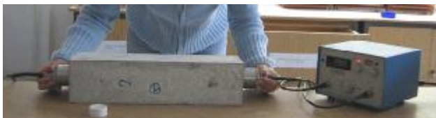
Slika 18 – Merenje brzine prolaza ultrazvučnih talasa radi određivanja E_d
