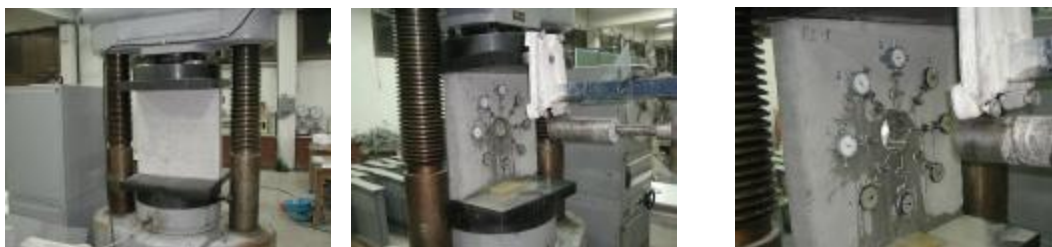
Slika 3. Postupak određivanja koeficijenata baždarenja u laboratorijskim uslovima [4]
