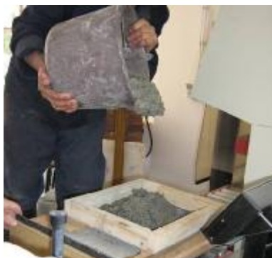
Slika 5a – Određivanje otpornosti na segregaciju samougrađujućih betona pomoću "Sieve segregation resistance test"-a (priprema i merenje mase)
