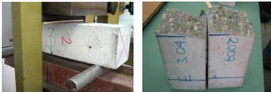
Slika 11 - Ispitivanje čvrstoće betona na zatezanje pri savijanju
