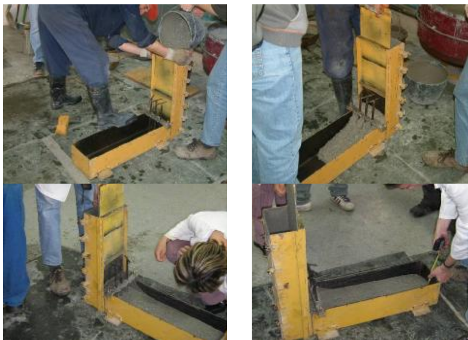
Slika 3 – Određivanje sposobnosti prolaska metodom L -boksa
