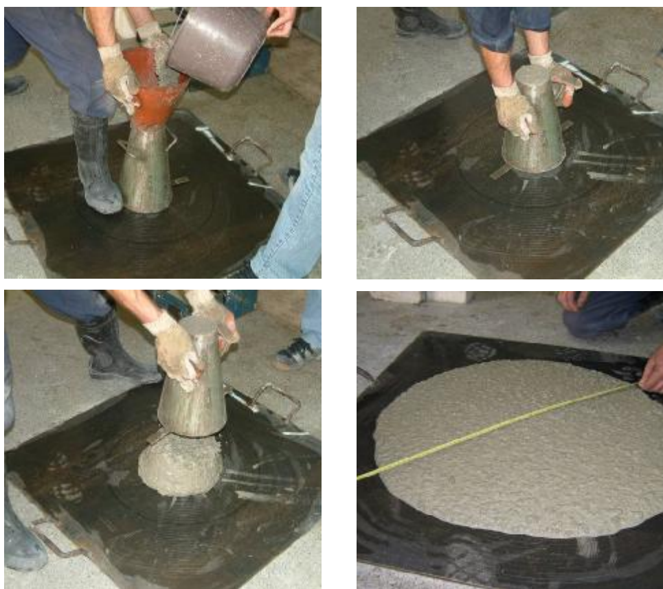
Slika 1 – Određivanje klase konzistencije metodom sleganja
