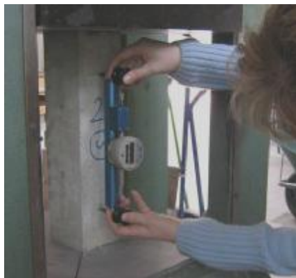
Slika 16 – Merenje dilatacija betona pri pritisku, radi određivanja modula elastičnosti
