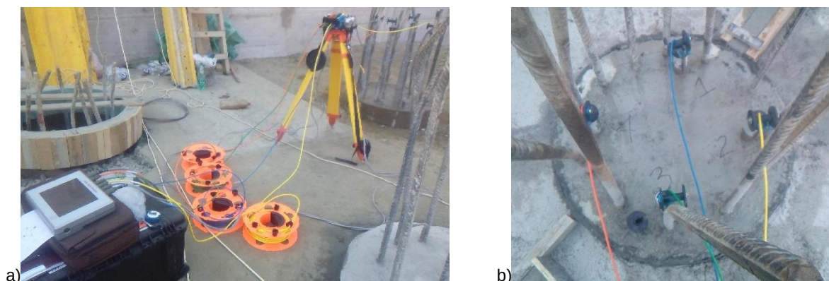
Slika 13. a) tripod za kablove sa senzorima, uređaj za akviziciju, memorisanje, procesiranje i vizuelizaciju podataka povezan sa sondama; b) povezane i postavljene sonde u cevima
