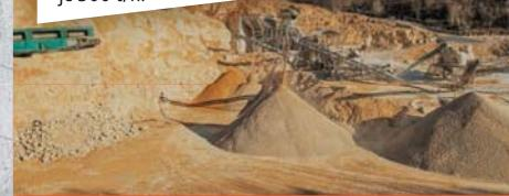
Za spravljanje betona koristimo drobljeni krečnjački agregat sa našeg kamenoloma, deklarisanih frakcija, kontrolisane vlažnosti. Kompletan proces proizvodnje i kontrole kvaliteta vršimo prema važećim standardima.
