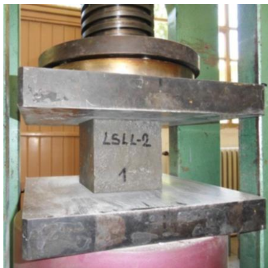
Slika 2. Određivanje čvrstoće pri pritisku [8] Figure 2. Determination of the compressive strength [8]
