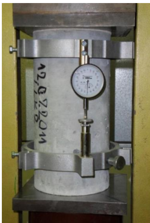
Slika 3. Određivanje statičkog modula elastičnosti [10] Figure 3. Determination of the static modulus of elasticity [10]
