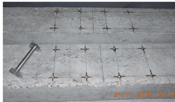
Slika 5. Raspored mjernih mjesta za mjerenje dilatacija Figure 5. Disposition of dilatation measurement points
