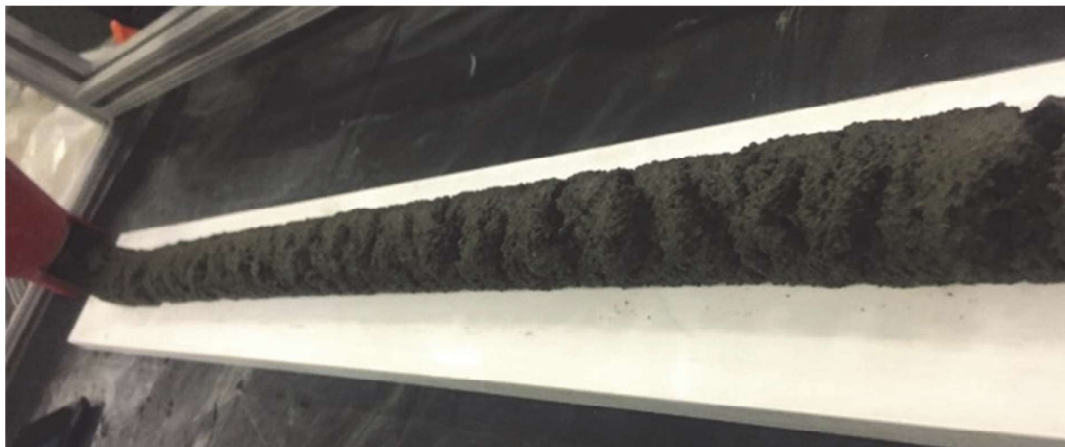
Slika 9. Kvalitet površine – odvajanje odštampanog sloja usled slabe kohezije i prekomerne krutosti mešavine za štampanje [10]
