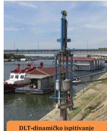
DLT-dinamičko ispitivanje šipova
